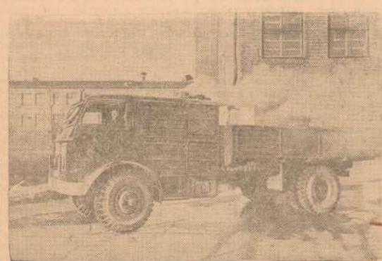
Москва. Конструкторское бюро паровых автомобилей научно-исследовательского автомобильного и моторного института (НАМИ) создало монтильный 6-тонный паровой автомобиль, предназначенный для перевозки грузов в лесных и угольных районах.
