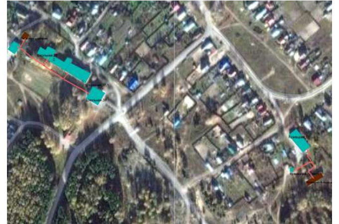
Рисунок 3 - Схема тепловых сетей от котельных школы и больницы с. Клязьминский Городок
